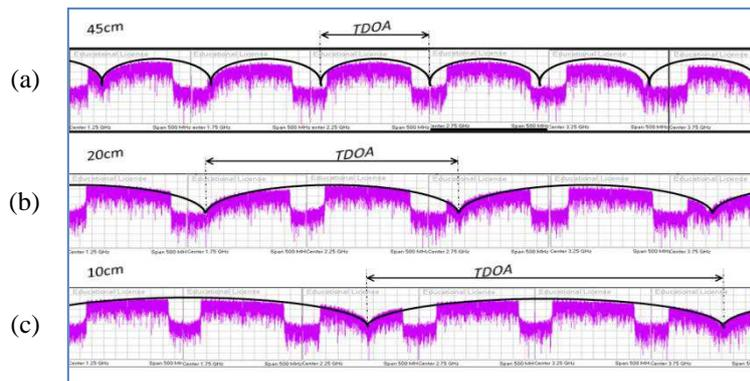
Figure 4. Spectres obtenus par concaténation des signaux reçus dans le cas d'une TDOA de a) 2,22 ns b) 0,95 ns c) 0,65 ns.
