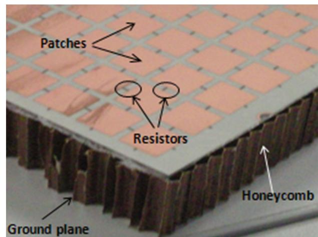
**Fig. 4** Prototype
