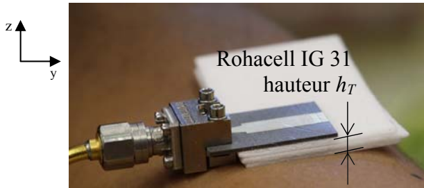
Figure 5. Mesure à différentes hauteurs h_T du corps humain.
