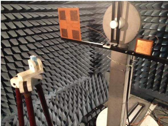
Figure 3. Dispositif de mesure dans la chambre anéchoïde.
