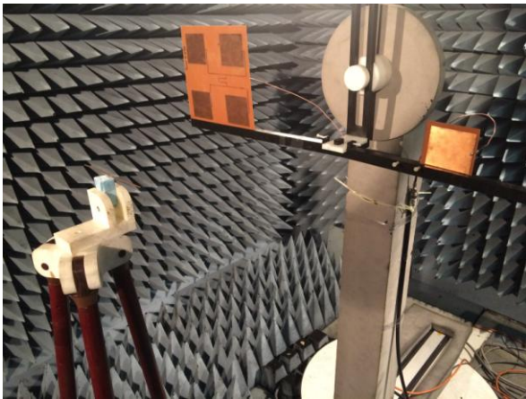
Figure 3. Dispositif de mesure dans la chambre anéchoïque.
