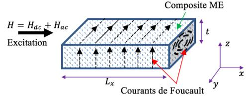
Figure 2 : Illustration des courants de Foucault
