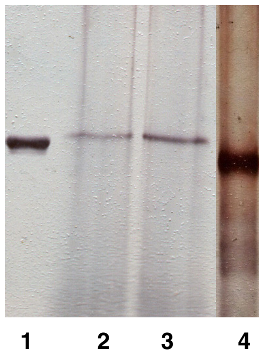
Fig. 8. Analyse électrophorétique de BSA adsorbée sur des échantillons de SnO 2 polarisés à +1,5 V/ECS en présence de NaCl 0,5 M pendant 30 min. (2), 2 heures (3) 48 heures (4), marqueur BSA (1).
