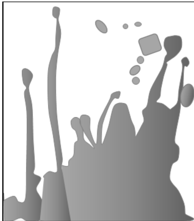
Figure 2. Atomisation d'une solution d'eau distillée 80% de glycérine, à la fréquence de 20 Hz, d'après Goodridge xiii . On observe une surface extrêmement perturbée avec des fibres donnant naissance à des gouttelettes.
