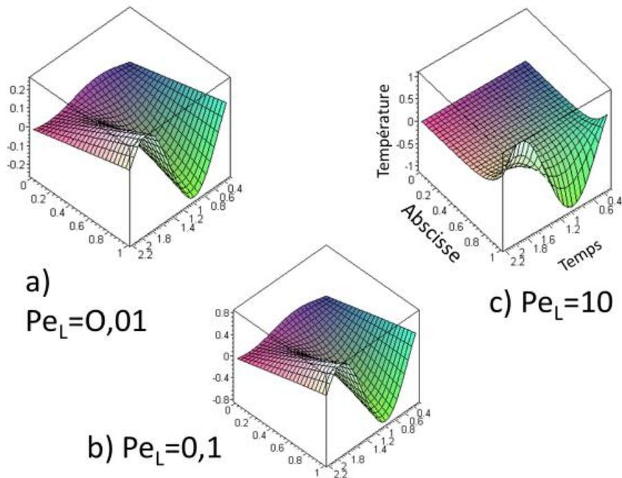
**Figure 4.** Influence du nombre de Péclet (inverse de  $\theta$ ) ( $Pe=0,01 ; 0,1 ; 10$ ) pour des valeurs identiques des autres paramètres  $\varepsilon = 1, h = 10, u = 10, A = 10, B = 100$  Les axes correspondent à des coordonnées réduites : température  $T'_{l\text{réd}}$  (équation 9), abscisse  $\xi = x/x_s$ , temps  $\tau = t/\tilde{\tau}_T$ .
