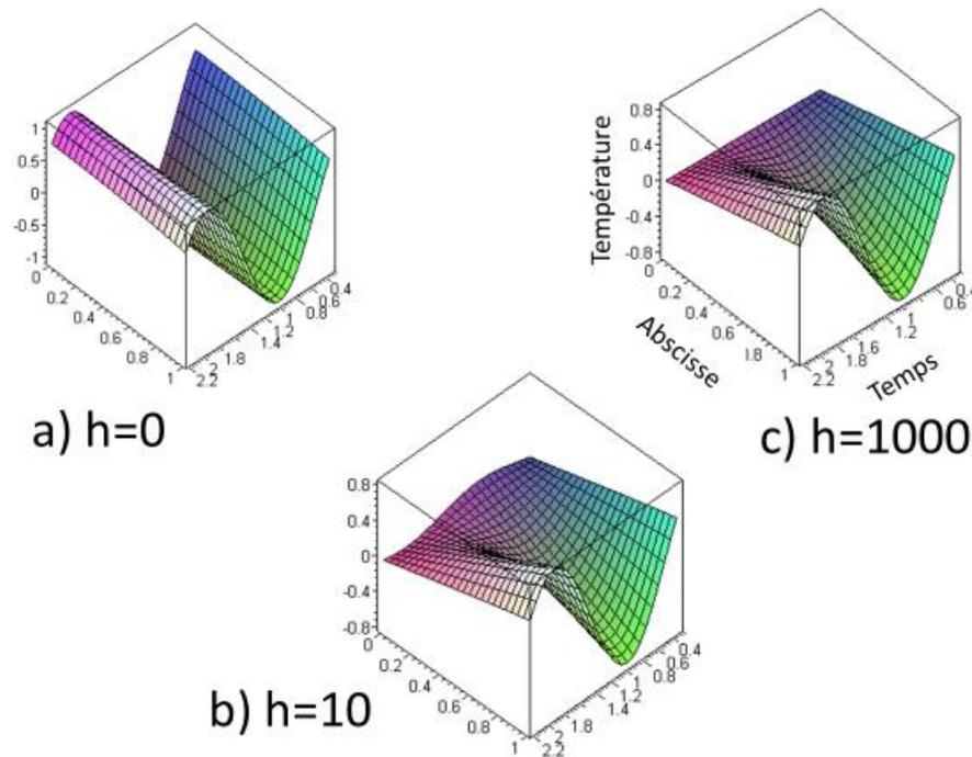
**Figure 3.** Influence du coefficient d'échange ( $h=0 ; 10 ; 1000$ ) pour des valeurs identiques des autres paramètres  $\varepsilon = 1, Pe_L = 0,1(\theta = 10), u = 10, A = 10, B = 100$ . Les axes correspondent à des coordonnées réduites : température  $T'_{1\text{réd}}$  (équation 9), abscisse  $\xi = x/x_S$ , temps  $\tau = t/\tilde{t}_T$ .
