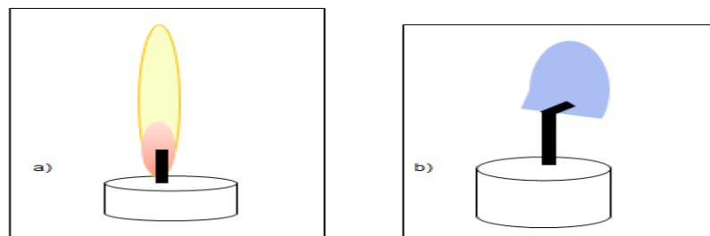
Figure2. Représentation schématique de flammes de bougie observées par Carleton et Weinberg en vol parabolique : a) sous gravité normale (1g), b) en micropesanteur (0g) 2 .
