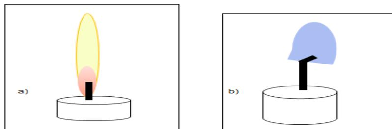
Figure2. Représentation schématique de flammes de bougie observées par Carleton et Weinberg en vol parabolique : a) sous gravité normale (1g), b) en micropesanteur (0g)<sup>2</sup>.
