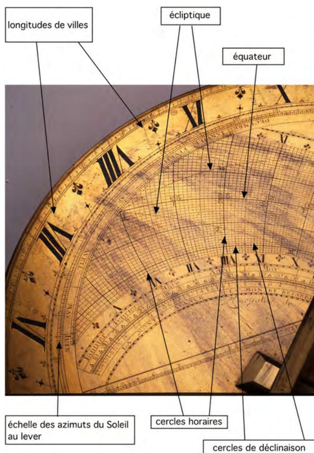
**Figure 5** – Détails sur les informations astronomiques figurant de la partie correspondant aux heures du matin.
