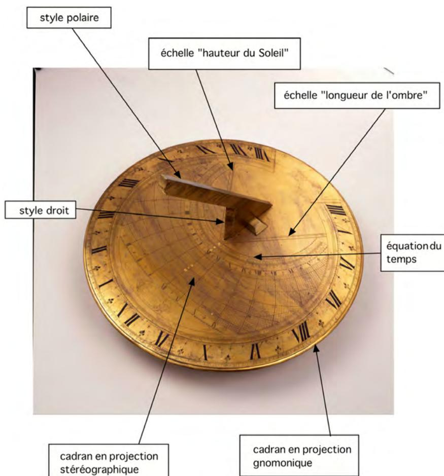
**Figure 2** – Détails sur les informations astronomiques figurant sur le double cadran.
