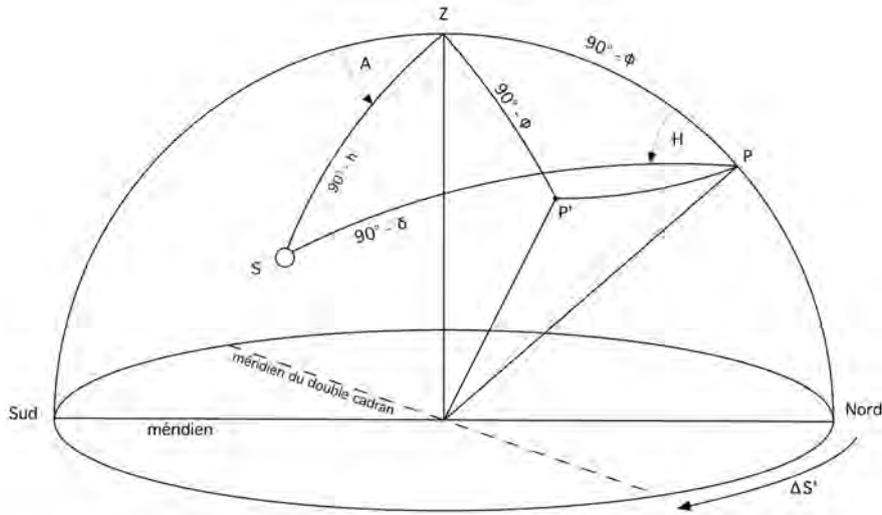
**Figure 8** – Pour orienter le double cadran sur le méridien, on le fait pivoter autour de la verticale du lieu (zénith) d’un angle  $\Delta S'$  : au lieu de pointer vers le pôle céleste Nord  $P$ , le style polaire pointe ici en  $P'$  (Nord-Est). Les deux cadrans solaires, dont un dépend de l’azimut et de la déclinaison du Soleil, indiquent le même angle horaire uniquement si le style pointe vers  $P$ .
