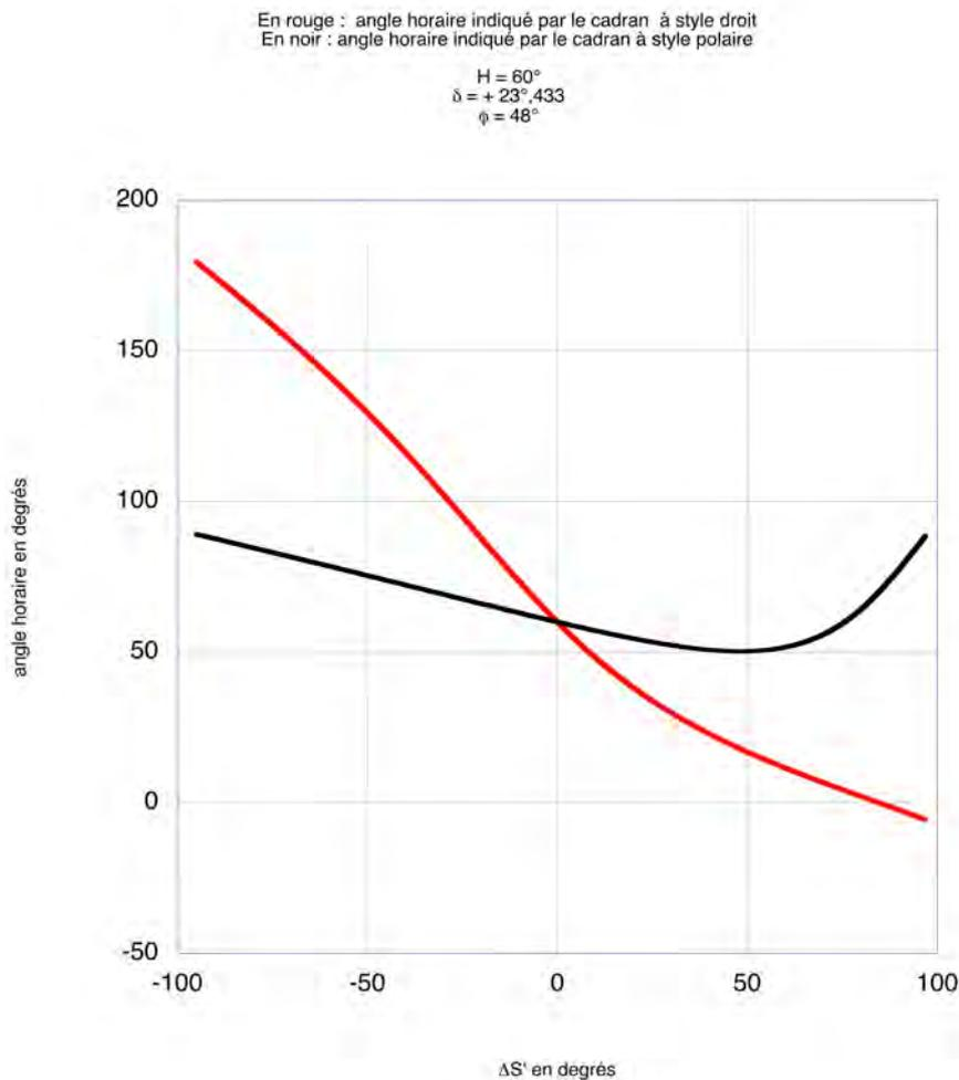
**Figure 9** – Les deux courbes tracées indiquent l’heure solaire d’un double cadran dont on cherche l’orientation au solstice d’été. On oriente l’ensemble un peu au hasard au début, en partant ici du Nord-Ouest pour aller vers le Nord-Est. Plus on se rapproche de la direction du méridien, plus les deux cadrans indiquent une heure voisine jusqu’à la coïncidence : le cadran est alors dans le plan méridien.
