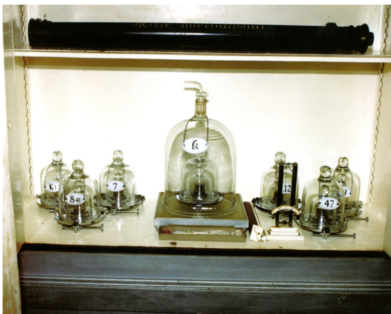
Fig. 7. Dépôt de prototypes métriques au Bureau international des poids et mesures ; en haut, le mètre international de 1889 dans son étui métallique ; en bas, le kilogramme international, \mathcal{K} , sous ses trois cloches en verre, avec ses six témoins, numéros 7, 43, K1, 47, 8 41 et 32, dans le dépôt des prototypes métriques au BIPM où il fut déposé après son adoption par la première Conférence générale des poids et mesures, le jeudi 26 septembre 1889. Ce prototype restera l'unité officielle de masse jusqu'au 20 mai 2019, lorsque entrera en vigueur la nouvelle définition basée sur une valeur numérique fixe de la constante de Planck. Le témoin numéro K1 est un des trois cylindres de platine iridié, K1, KII et KIII, livrés par Johnson Matthey à Londres en 1878, qui furent ajustés et polis à Paris et comparés au kilogramme des Archives en 1880. Le cylindre KIII, dont la masse fut trouvée la plus proche de celle du kilogramme des Archives, fut choisi comme futur prototype international du kilogramme en 1883 et sanctionné comme tel en 1889. En 1884, quarante cylindres en platine iridié furent livrés par Johnson Matthey, et ensuite polis et ajustés au BIPM (à \pm 1 mg près). Les numéros 1 à 40 leur furent attribués. Au cours de la conférence, trente-quatre étalons furent attribués par tirage au sort aux États membres de la Convention du mètre. Les numéros 9, et 31 furent attribués au BIPM comme prototypes d'usage ; les numéros K1, 7, 8 41 et 32 devinrent témoins. Le 8 41 indique qu'à un certain moment il y eut confusion pour savoir si cet étalon était le numéro 8 de l'alliage de 1884 ou le premier étalon d'une nouvelle livraison de Johnson Matthey. En 1938, deux autres étalons furent choisis comme témoins, les numéros 43 et 47 fabriqués à partir d'autres cylindres livrés ultérieurement par Johnson Matthey. Le nombre de témoins de \mathcal{K} fut ainsi porté à six. En 1997, le kilogramme international et ses témoins furent transférés dans un nouveau coffre moderne, à côté de l'ancien.
