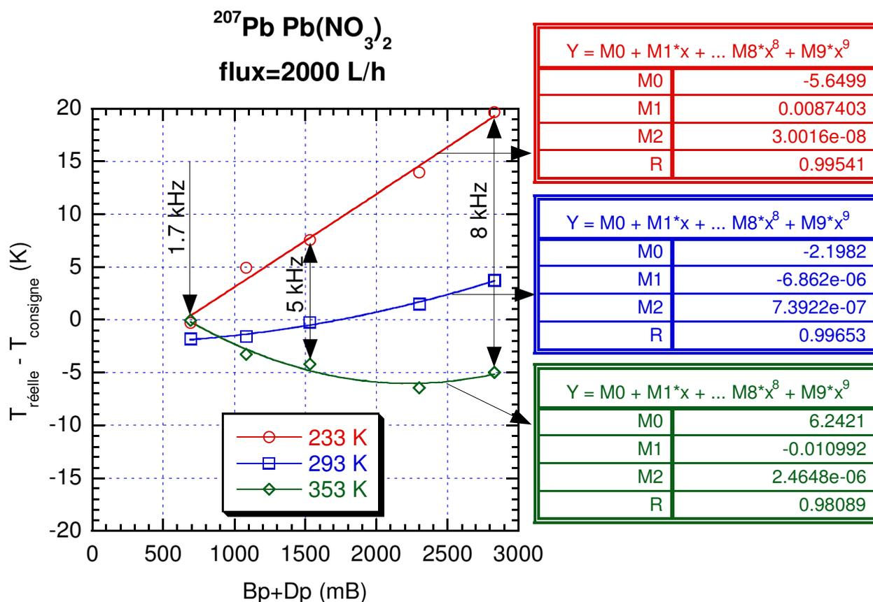
Les figures 17 et 18 ainsi que le tableau 2 montrent une variation importante de la température de l'échantillon en fonction du bearing et du drive. A basse température (233 K), l'échantillon s'échauffe fortement. En effet, la température de l'échantillon monte de 0.4 degré à 1.7 kHz ( $B_p+D_p=690$  mB), de 7.8 degrés à 5 kHz ( $B_p+D_p=1530$  mB) et de 19.3 degrés à 8 kHz ( $B_p+D_p=2830$  mB). Le comportement est quasiment linéaire.
