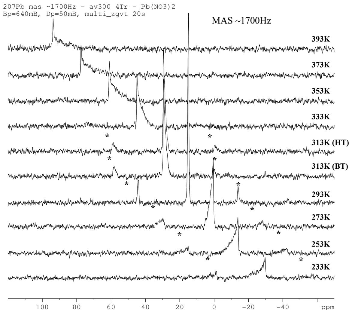
Figure 14 : spectres  $^{207}\text{Pb}$  en fonction de la température
