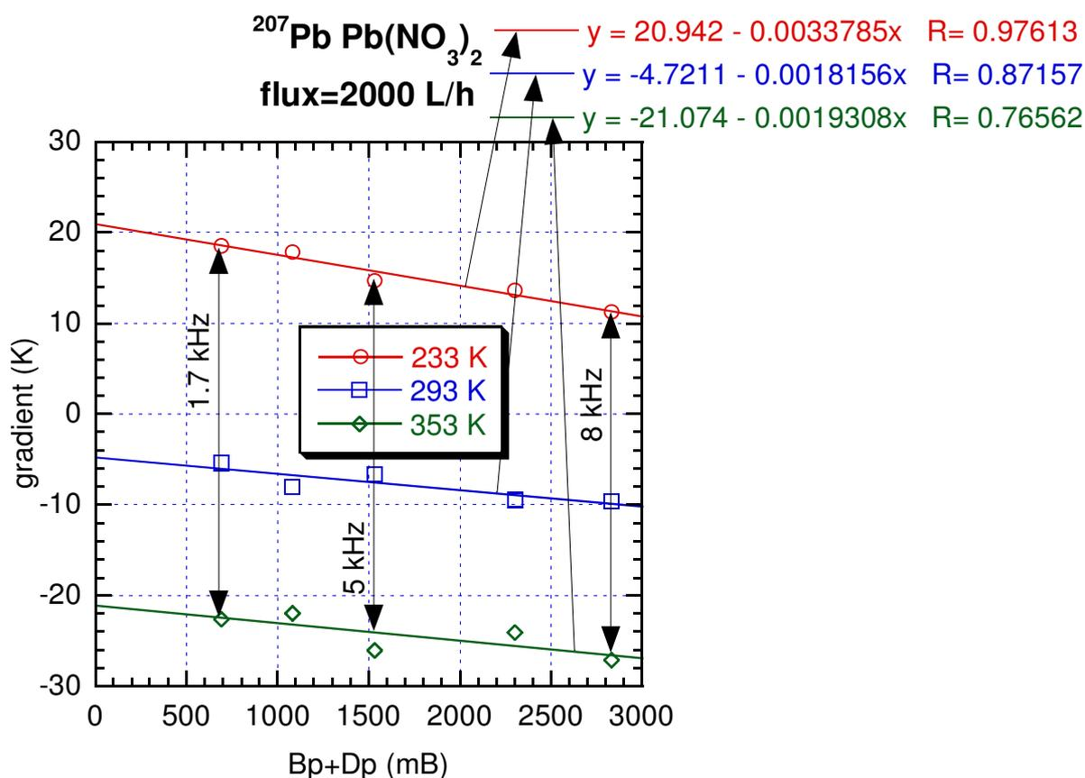
Figure 19 : gradient de température en fonction du bearing et du drive
