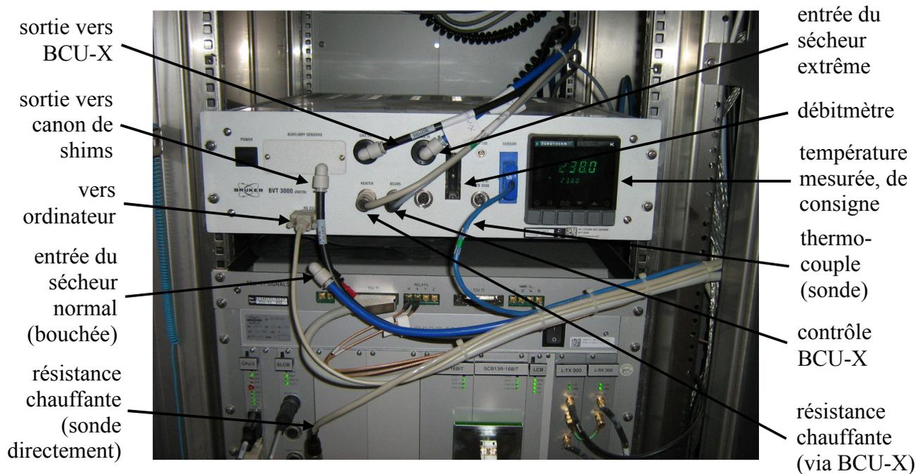
Figure 6 : unité de contrôle de température (BVT)
