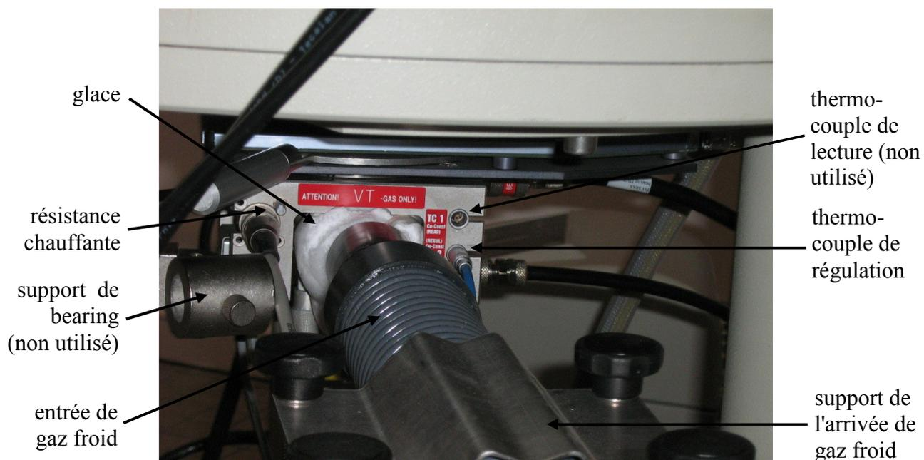
Figure 10 : arrière de la sonde DVT
