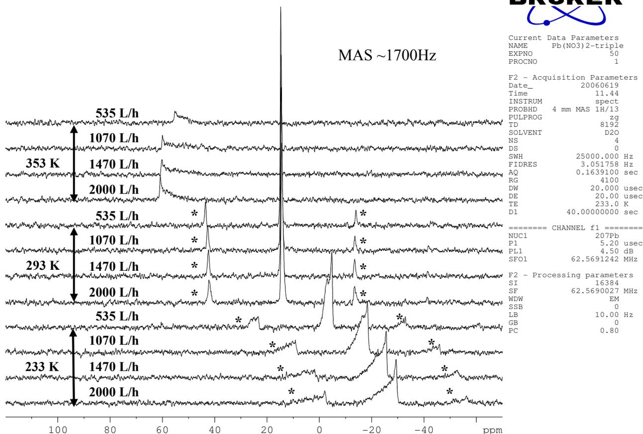
Figure 20 : spectres <sup>207</sup>Pb en fonction du flux à température contrôlée
