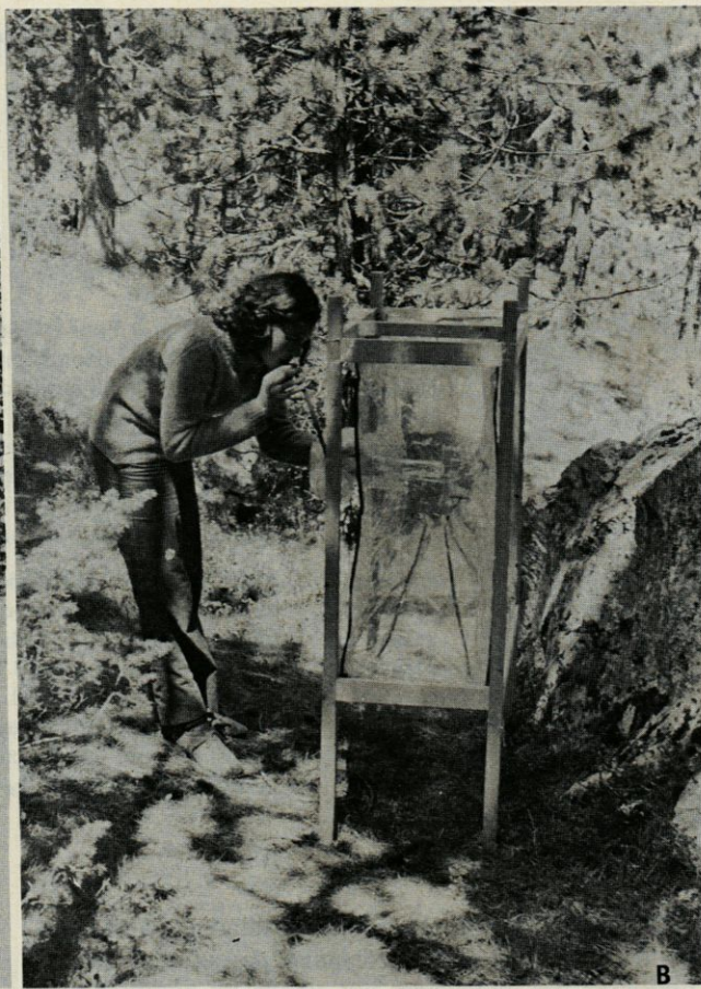
Fig. 1 B. — Pièges pour Culicidés diurnes. Construit en plastique souple transparent, ce piège comporte dans sa partie inférieure, une nasse maintenue ouverte par deux élastiques; un pain de 200 grammes de carboglace placé dans un sac en plastique, est suspendu à son toit. Les Insectes piégés sont récoltés à l'aide d'un capteur à bouche.
