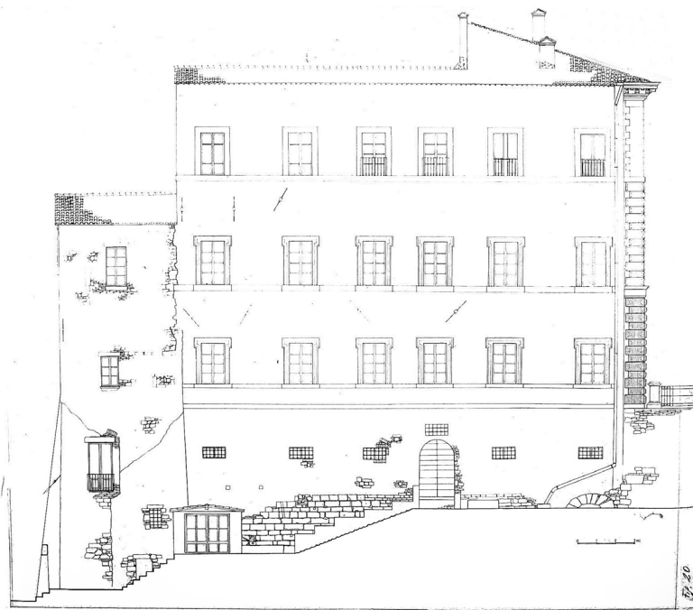
Fig. 2. Palazzo Atti, Todi. Rilievo del fronte verso valle (elaborazione dell'autore).
