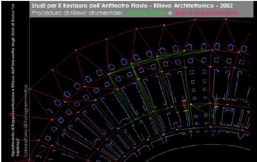
Fig. 5. Anfiteatro Flavio, Roma. Rilevamento della pianta del piano terra (elaborazione dell'autore).
