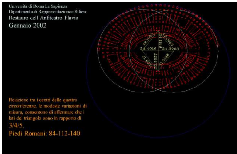
Fig. 8. Anfiteatro Flavio, Roma. Individuazione dei quattro triangoli con vertici nei centri di tracciamento che hanno la caratteristica di avere i lati in rapporto 3, 4, 5 (triangolo sacro degli egizi); i lati in piedi romani misurano 84, 112, 140. Si tratta di regole ben note ai gromatici romani come Balbo, che ne parla esplicitamente nei trattati dei Gromatici Veteres (elaborazione dell'autore).
