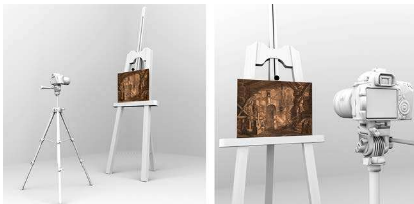
Fig. 3. Simulazione del set allestito per l'acquisizione RTI (elaborazioni grafiche dell'autrice).
