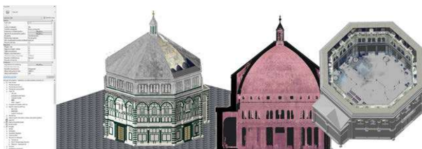
Fig. 8. Viste del modello BIM del Battistero di San Giovanni e della sovrapposizione con la nuvola di punti (elaborazione grafica dell'autrice).
