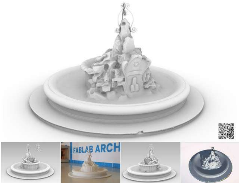
Fig. 7. In alto al centro: modello tridimensionale ottenuto integrando la mesh fotogrammetrica con la modellazione matematica delle componenti metalliche. In basso a destra il QR code attraverso il quale è possibile scaricare il target e la versione beta dell'applicazione di studio realizzata per la visualizzazione della fontana in realtà aumentata. In basso da sinistra: il modello realizzato per la stampa 3D, con le componenti metalliche ridimensionate per adattarsi alle dimensioni degli ugelli; stampa realizzata con stampante SLA Form2 presso il laboratorio FabLab Architettura Sapienza; il modello decimato per l'applicazione di AR; il modello visualizzato con l'applicazione di realtà aumentata, realizzata con i software Unity e Vuforia (elaborazioni dell'autrice).
