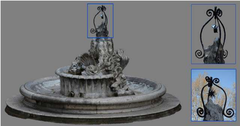
Fig. 5. A sinistra: il modello mesh texturizzato. A destra: confronto di una porzione della superficie mesh con una foto (elaborazione grafica dell'autrice). Il modello fotogrammetrico presenta una alterazione della geometria di alcune componenti metalliche sulla sommità.
