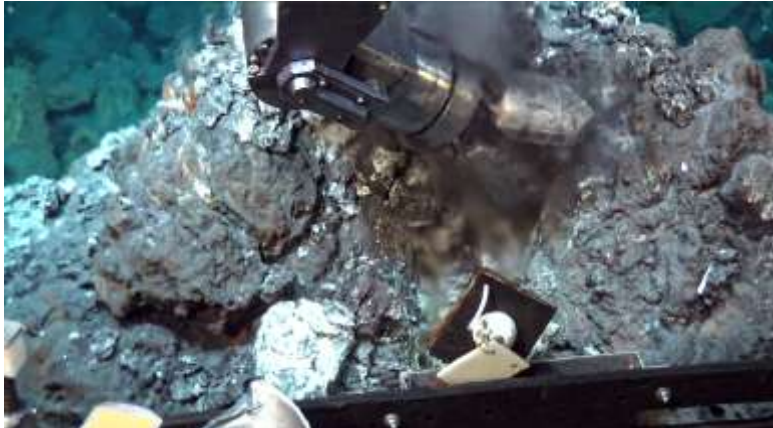
Prélèvement de bordure de cheminée d'anhydrite (base de la cheminée). Même cheminée que pour les bouteilles titanes et la BEG.
