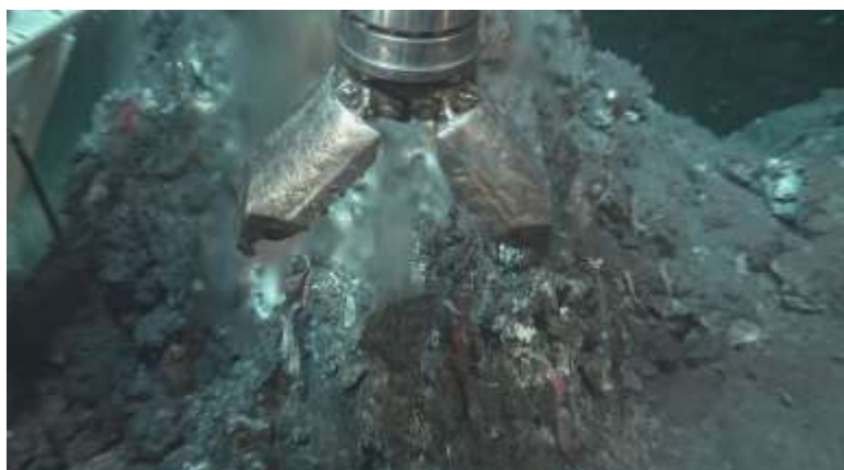
Prélèvement d'une petite cheminée d'anhydrite (après effondrement de la grande) pour la microbiologie.
