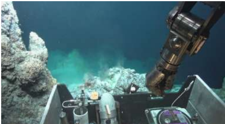
Prélèvement d'une bordure de la base d'une cheminée d'anhydrite. Même cheminée que pour les prélèvements de fluides.
