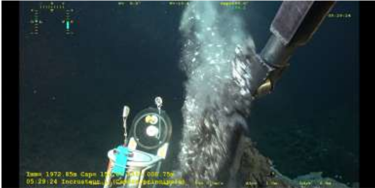
Cheminée d'anhydrite tombée dans le panier après la tentative de prélèvement pour la PBT5
