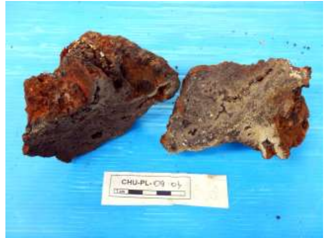
Bloc de sulfures à la surface oxydée prélevé au pied d'une cheminée en fin d'activité hydrothermale (diffusion).
