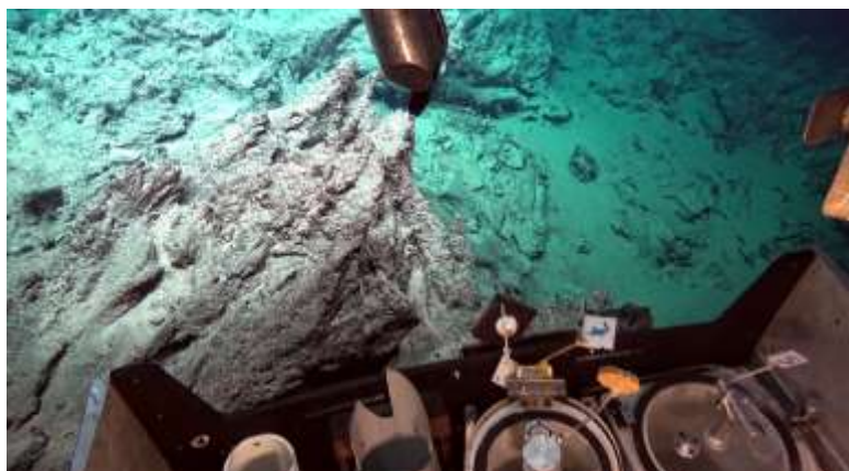
Prélèvement d'une cheminée d'oxyhydroxyde de manganèse sur un site fossile situé au sud d'AsterX
