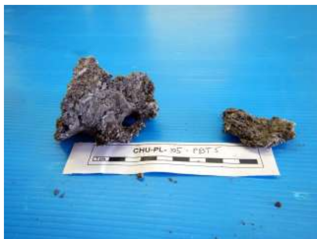
Prélèvement d'une petite cheminée d'anhydrite (après effondrement de la grande) pour la microbiologie.
