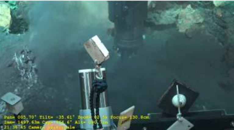
Prélèvement d'une bordure de la base d'une cheminée d'anhydrite. Prise d'un morceau indurée qui finalement est composée quasi exclusivement d'anhydrite.
