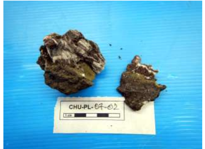
Prélèvement de la bordure d'une cheminée d'anhydrite. Zone finalement pas idéale pour le prélèvement de fluide
