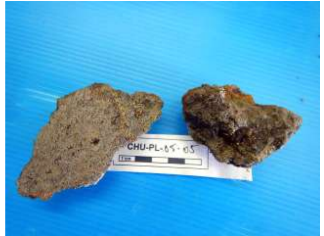
Petit bloc de sulfures semi-massif prélevé sur un site composés de blocs de cheminées anciennes. Site encore actif principalement sous forme de diffusion.
