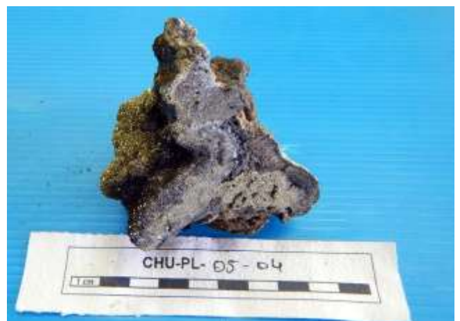
Bloc de base de cheminée prélevé après la prise du fluide hydrothermal (270°C) avec BEG et les bouteilles titanes
