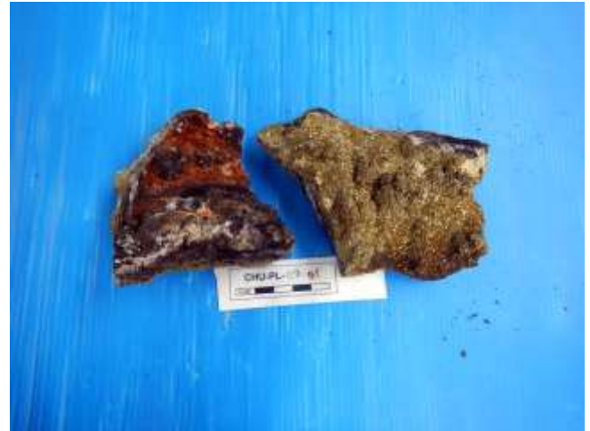
Prélèvement de bordure de cheminée d'anhydrite (base de la cheminée). Même cheminée que pour les bouteilles titanes et la BEG.
