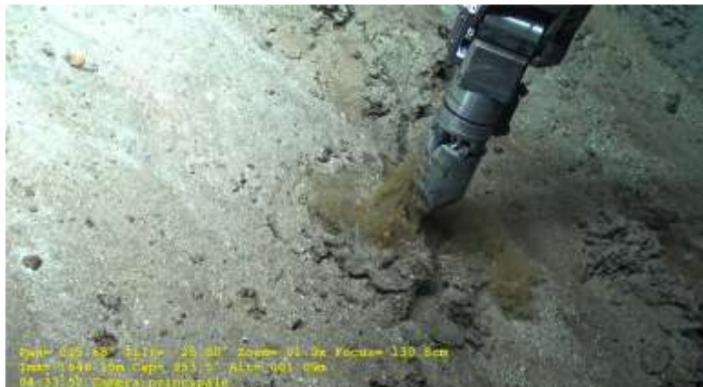
Prélèvement d'une cheminée très oxydée. Le morceau a été totalement lessivé à la remontée du ROV et n'était donc plus présent.
