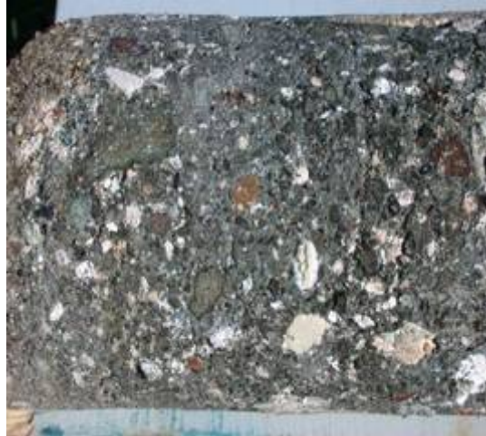
Fig. 2. Carotte 116 du môle sud de Caesarea Maritima (Israël) comportant de la pouzzolane de Baïes (source : projet ROMACONS)
