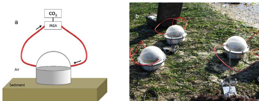
FIGURE 1.1 – (a) Schéma de fonctionnement d'une chambre benthique à l'émersion. L'analyseur de gaz (IRGA) permet de mesurer la pression partielle en CO_2 à l'intérieur de la chambre. (b) Mesure de la production nette (NCP) d'un herbier à l'émersion à l'aide de chambres benthiques.
