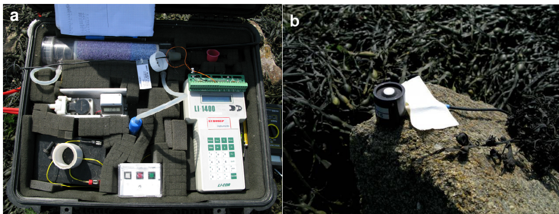
Figure I.5. : Le circuit fermé (a), contenant l'analyseur de gaz à infrarouge, est relié à la chambre benthique tandis que le capteur de PAR (b) est branché directement sur le data-logger.
