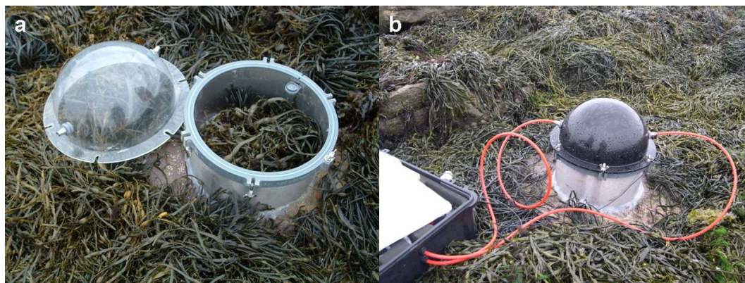
Figure I.7. : Lors du suivi mensuel des flux de carbone de la zone à A. nodosum , la chambre benthique est constituée d'une embase cylindrique et d'un dôme transparent (a) pour la mesure à la lumière ou d'un dôme opaque (b) lors de l'incubation à l'obscurité.
