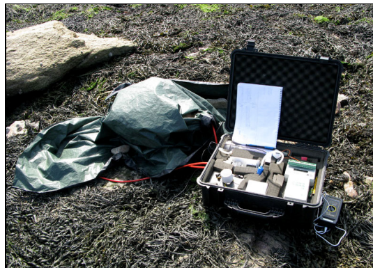
Figure I.9. : Mesure de la RC à l'aide de la chambre benthique placée sous une bâche opaque.
