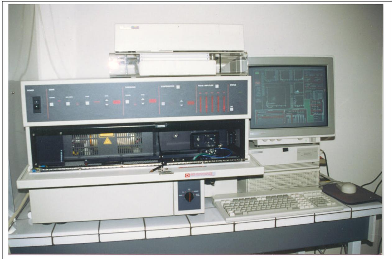
**Fig. II.3** Photographie d'ensemble d'un cytomètre en flux de type FACScan (Becton Dickinson, San Jose, CA).
