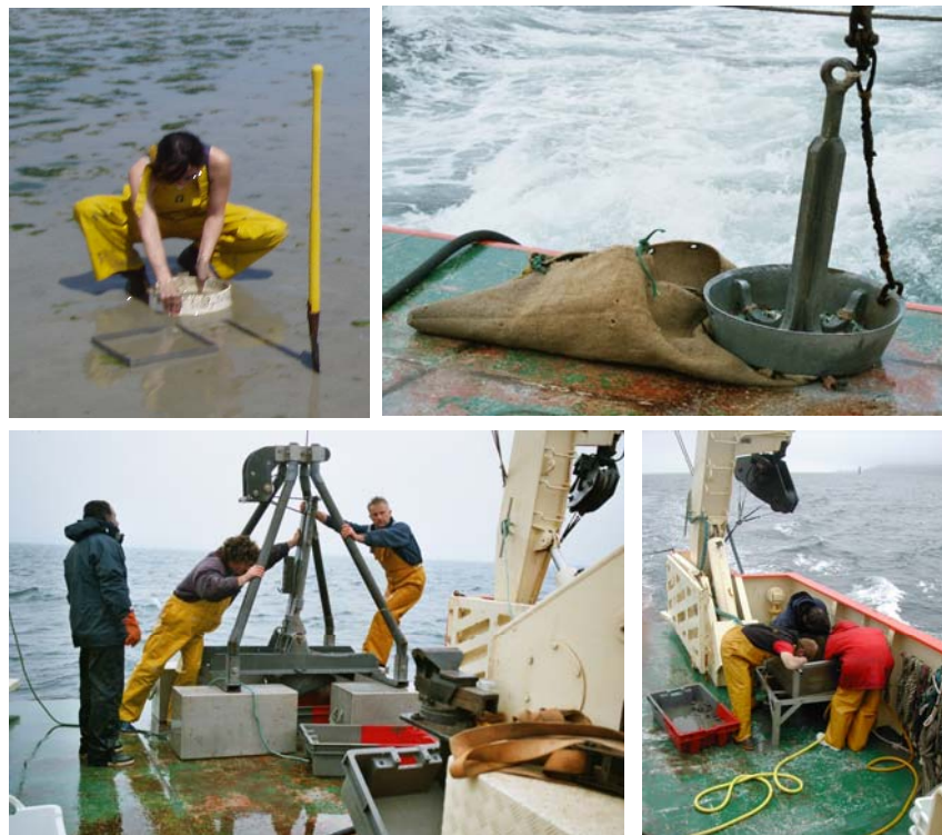
Figure I.2. Techniques d'échantillonnage des ophiures : En haut à gauche, quadrat, tamis et bêche pour les échantillons intertidaux d' A. brachiata . En bas à gauche, remontée de la Benne Hamon à bord du Côtes de la Manche. Le sédiment prélevé est ensuite tamisé et trié à bord (en bas à droite), afin de récupérer et fixer les échantillons subtidaux d' A. brachiata . En haut à droite, la drague Rallier du Baty pour les échantillons subtidaux d' O. fragilis , les échantillons sont triés de la même façon que ceux récoltés à l'aide de la Benne Hamon.
