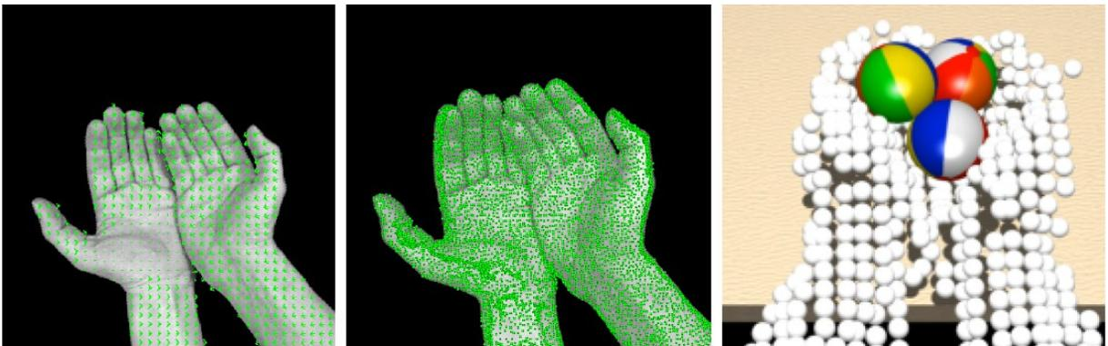
**Figure 1.10** - La surface de la main de l'utilisateur détectée avec la Kinect est représentée par des particules physiques qui interagissent avec des sphères virtuelles dans le simulateur. [Hilliges 12] [Van den Bergh 11]
