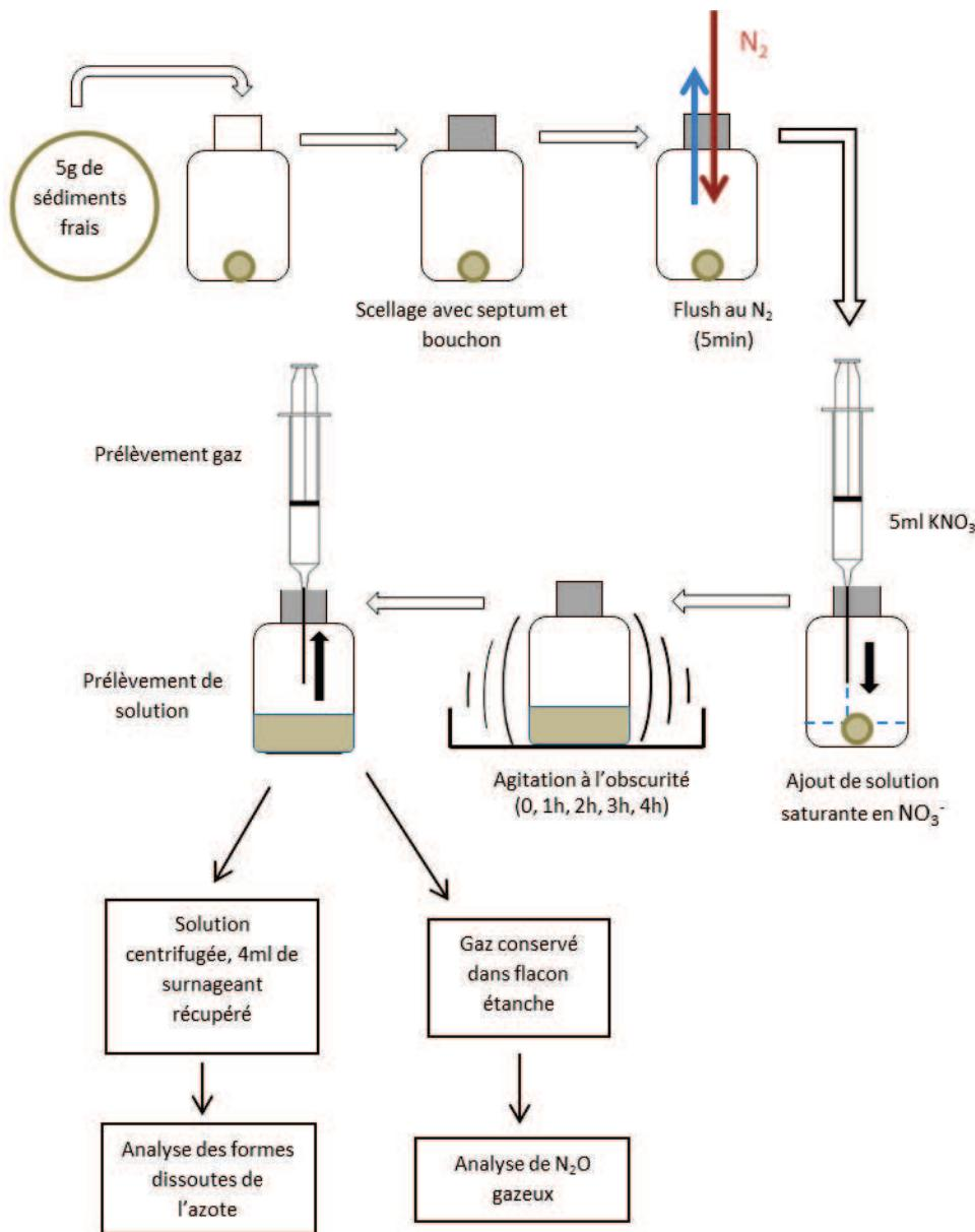
**Figure 2-9.** Schéma descriptif de mesure du potentiel de dénitrification. Pour la nitrification, le principe est le même, les seuls différences sont : l'étape de flush à l'air, et la solution de KNO<sub>3</sub> qui est remplacée par une solution (5 ml) de NH<sub>4</sub>Cl.
