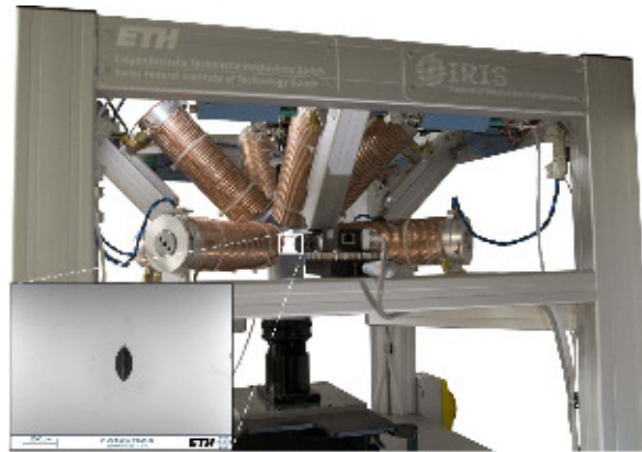
Figure 1.12 - Plateforme électromagnétique de l'OctoMag : 8 bobines à noyaux ferromagnétiques entourent l'espace de travail de la microparticule [Kummer 10].
