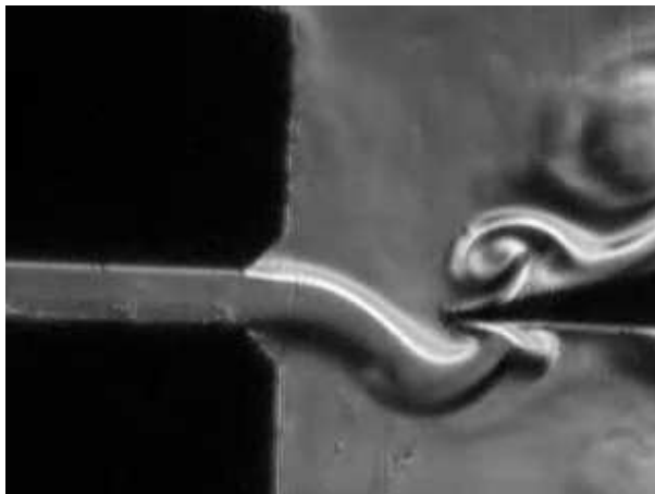
FIGURE 2.5 – Visualisation par strioscopie du jet oscillant sur son premier mode ( h = 1\text{mm} , W = 3\text{mm} , U_j = 12.5\text{m.s}^{-1} ).
