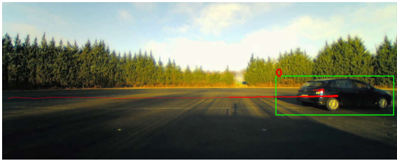
(a) Détection d'un véhicule (réctangle vert) et obtention de sa trajectoire (ligne rouge).
