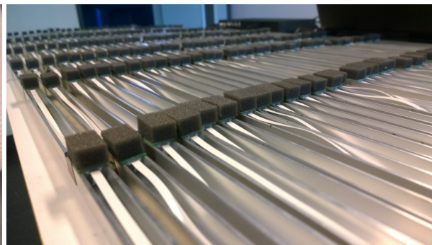
(d) 256 microphones montés sur profilé et équipés de leur protection au vent.
