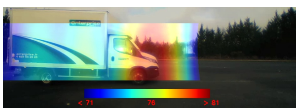
(b) Octave de 125 Hz - Dynamique : 10 dB.
