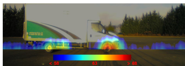
(e) Image acoustique - Octave de 1 kHz
