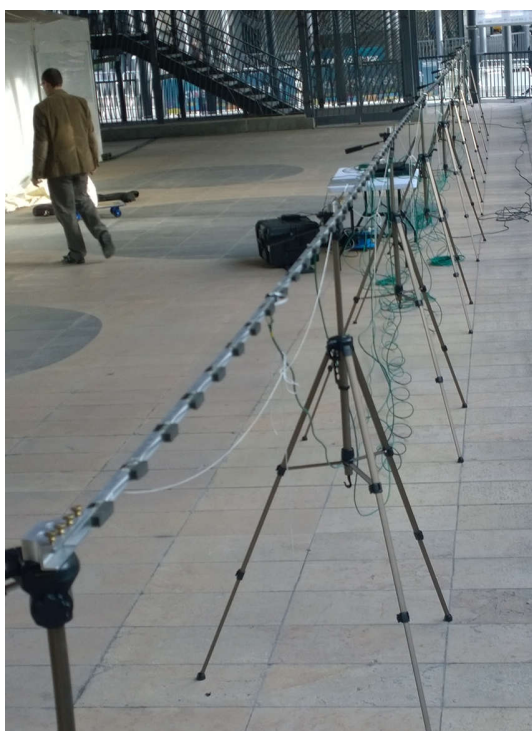
(a) Antenne sur pied à 1,6 m du sol imageant une rue en contre-bas .
