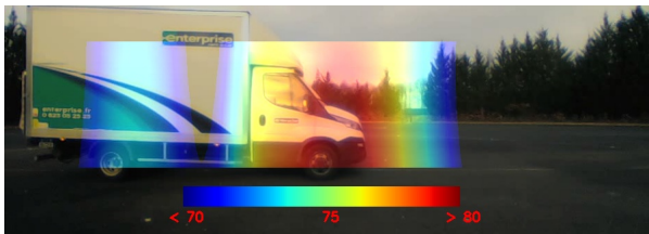
(b) Image acoustique - Octave de 125 Hz
