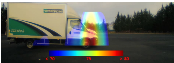
(c) Image acoustique - Octave de 250 Hz
