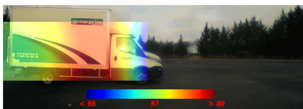
(a) Octave de 62,5 Hz - Dynamique : 3 dB.
