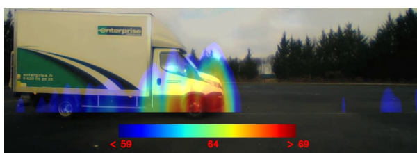
(d) Octave de 500 Hz - Dynamique : 10 dB.
