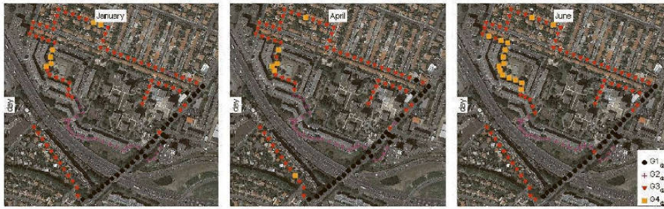
FIGURE 3 – Distribution des environnements sonores en fonction des saisons basée sur les quatre groupes diurnes - Les groupes se caractérisent par différentes valeurs du niveau sonore médian, de la variation du niveau sonore et de la balance spectrale - De Can et al. [29]
