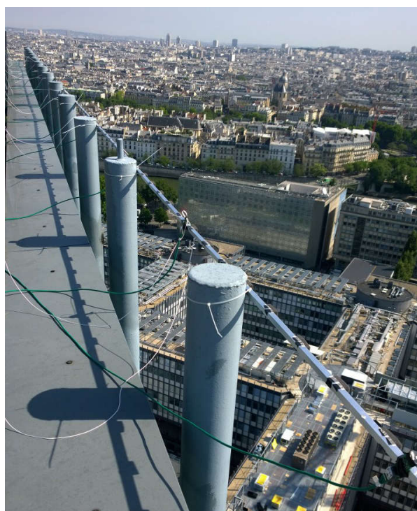
(b) Antenne accrochée sur support en haut de la tour Zamansky (90 m d’altitude).
