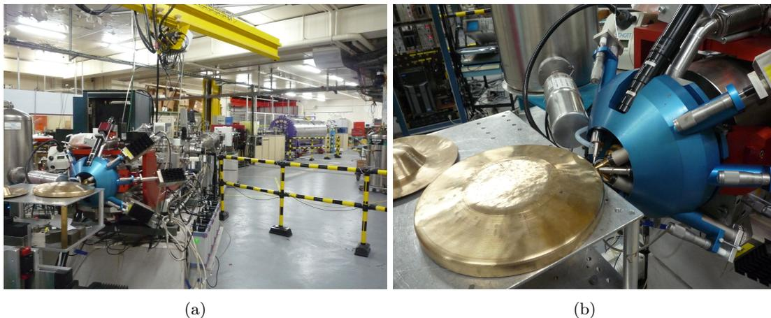
FIGURE 2.3 – Accélérateur Grand Louvre d'Analyses Élémentaires (AGLAE) pour l'analyse chimique par émission de rayons X induite par particules chargées (PIXE) du gong *xiaoluo*. (a) Vue globale du système. Le gong analysé est situé dans la moitié inférieure de l'image, tout à gauche. (b) Zoom sur le gong analysé.
