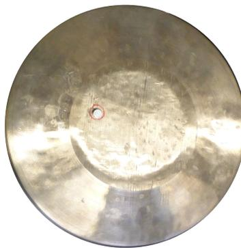
FIGURE 4.7 – Photo du gong et de l'aimant, placé décentré sur la partie centrale.
