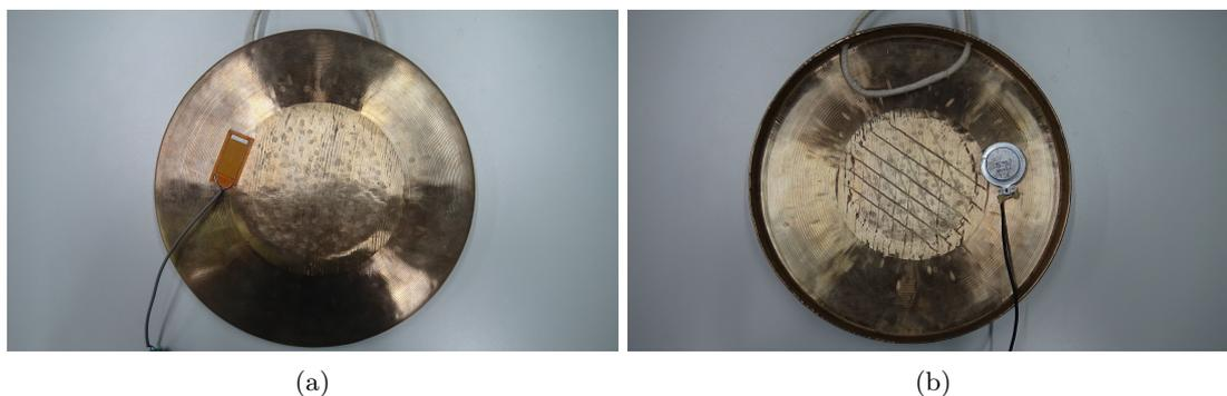
FIGURE 3.5 – Position (a) du capteur et (b) de l'actionneur utilisés pour le dispositif de contrôle expérimental.
