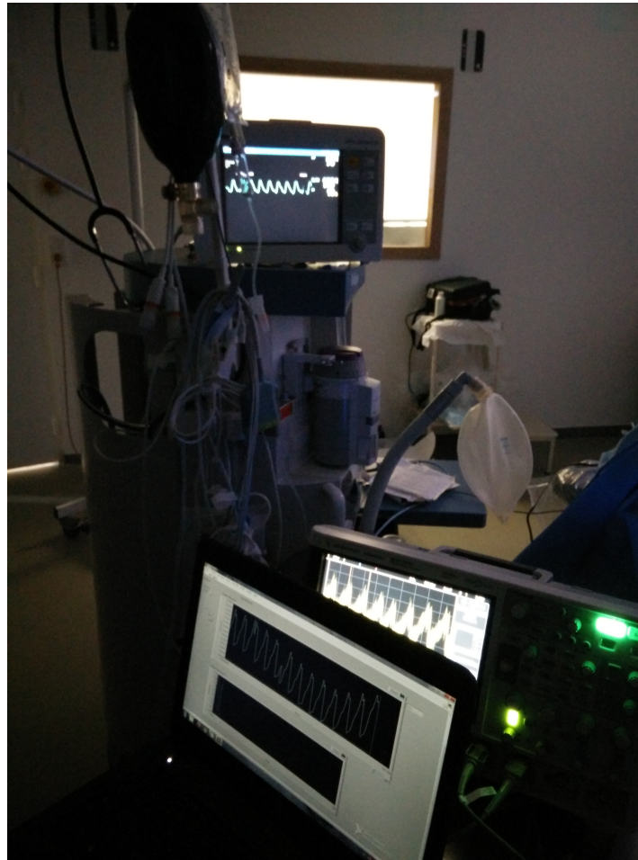
FIGURE A.2 – Acquisition in vivo du PPG en parallèle avec l'oscilloscope et la station d'anesthésie
