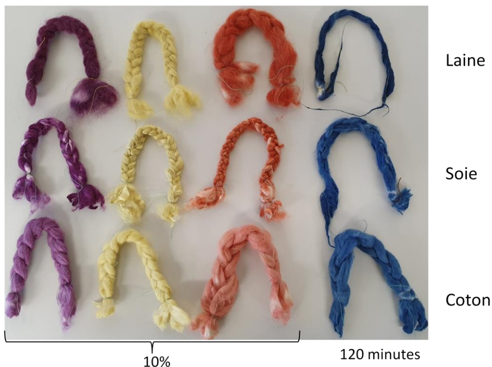
Figure 21 : préparation d'éprouvettes à base de Laine, Soie, Coton teints à la Cochenille, Garance, Genêt à 10% et à l'Indigo (bain de 120 min)
