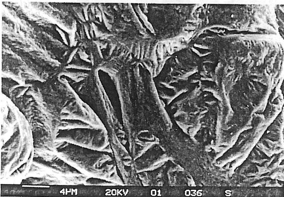
Figure II.3.2 : Electrode poreuse de zinc observée au M.E.B.
