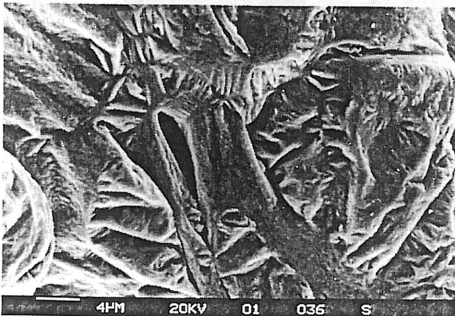
Figure II.3.2 : Electrode poreuse de zinc observée au M.E.B.
