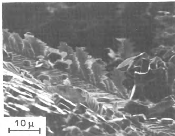
(d) Vitesse de rotation de l'électrode 500 tr/mn en présence de 10^{-4} M d'acétate de plomb.
