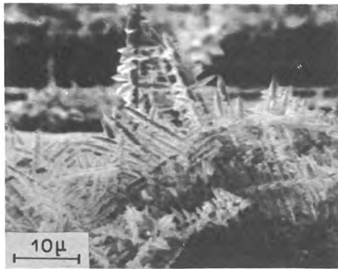
(a) Micrographie obtenue au microscope électronique à balayage (angle d'incidence 64^\circ ) d'un dépôt de zinc préparé à 3,5 \text{ mA cm}^{-2} , avec une électrode à disque tournant (1200 tr/mn) et l'électrolyte \text{ZnCl}_2 0,72M \text{NH}_4\text{Cl} 2,67M (pH = 5,2).
