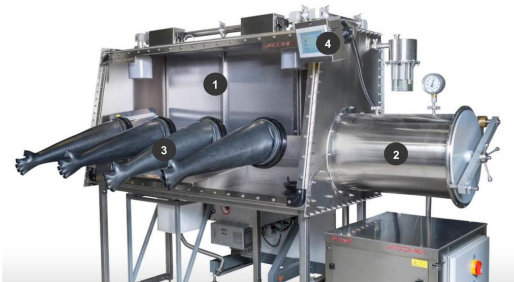
**Figure 2** | BaG Jacomex™ composée de ① l'enceinte anaérobie, ② le sas d'introduction/d'extraction, ③ les gants de manipulation et ④ le moniteur avec indicateurs de pression, d'humidité (ppm H<sub>2</sub>O) et d'oxygène (ppm O<sub>2</sub>).
